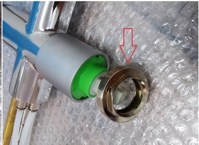
4. Estrarre la cartuccia dalla sua sede tirandola lateralmente. Controllarne lo stato, le guarnizioni e sostituirla se necessario
